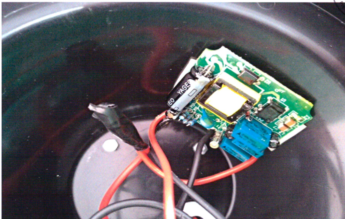
Figura 01: Detalhe da fonte interna do módulo LED amostral.
